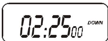
Fig. 2 – Exemplo de contagem regressiva programada para duas horas e vinte e cinco minutos
