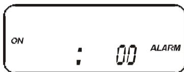
Fig. 3 – Programação do número de segundos de duração do modo alarme
